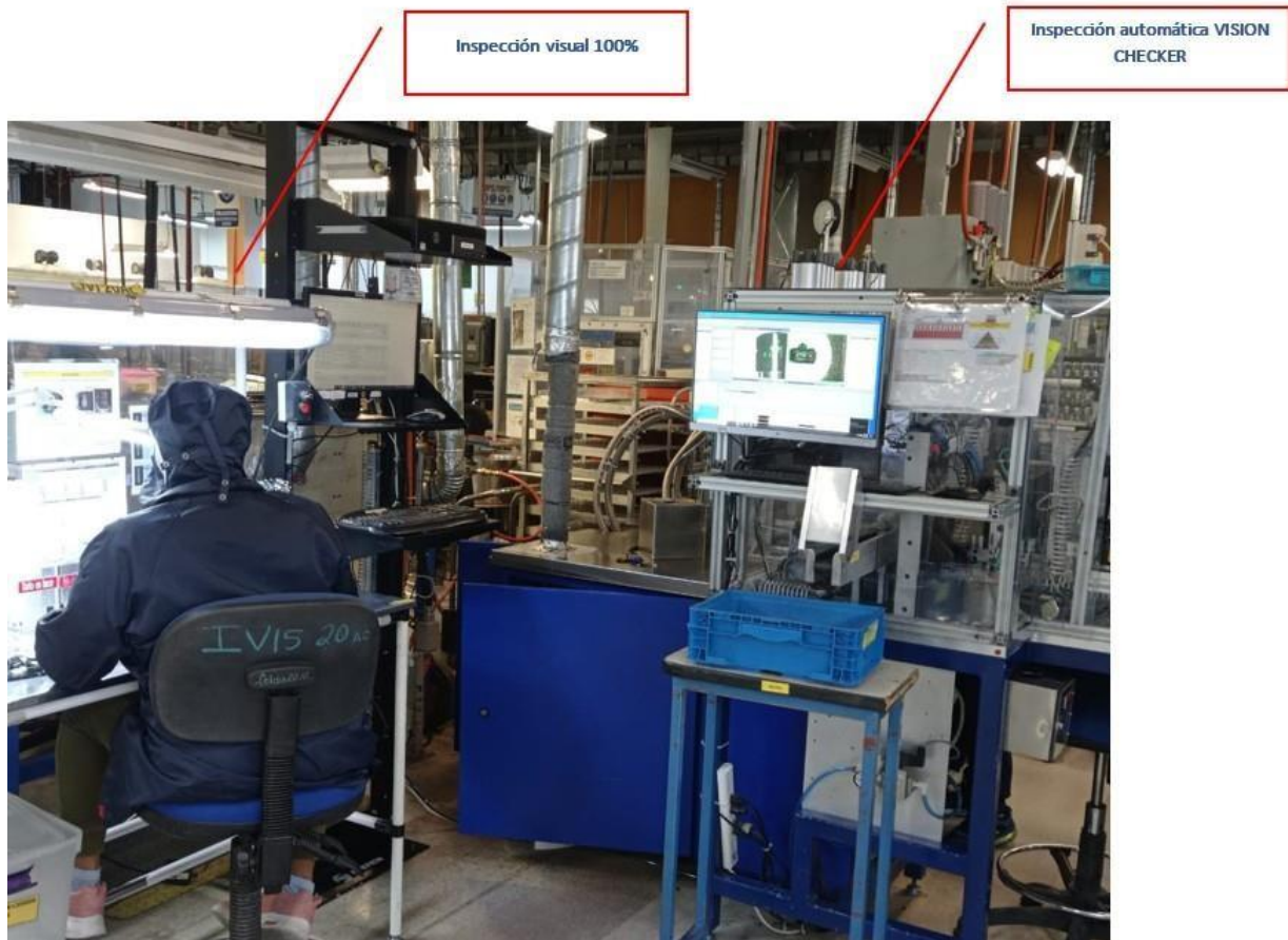
Imagen 9.1.1 Estación de inspección visual final
