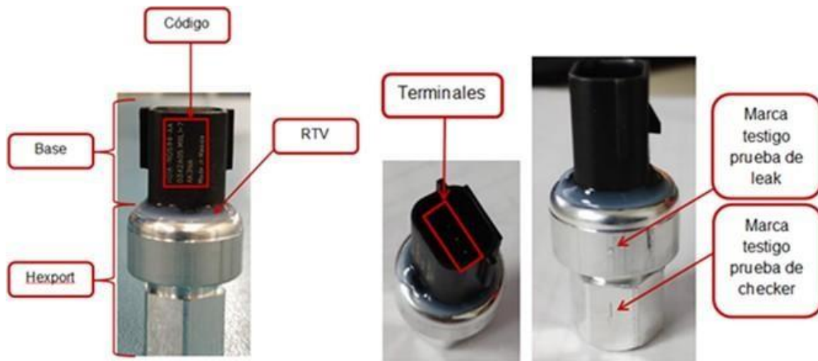
Imagen 4.1.4 Elementos externos a verificar en APT 12ACP82-1
